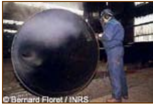
Meulage pour finition de grosses canalisations métalliques
